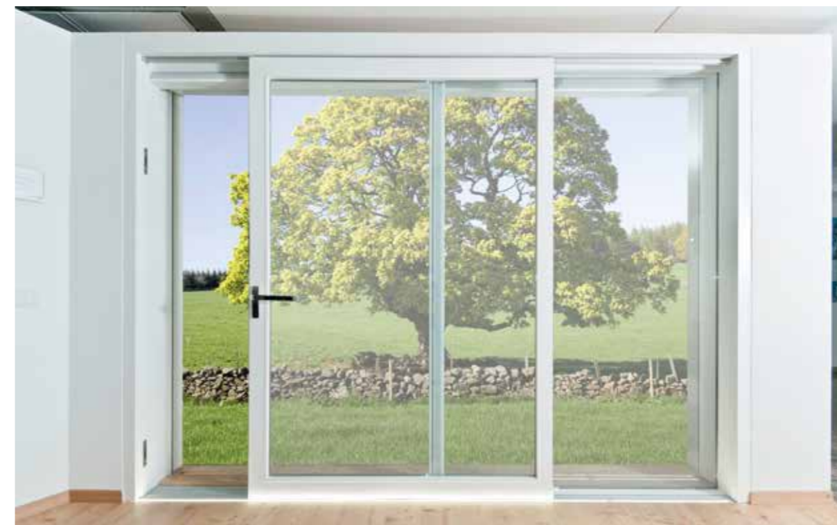
Portafinestra alzante scorrevole 2 ante apribili con guida sovrapposta in vetroresina e serratura di sicurezza con gancio e bocchetta incassata.
